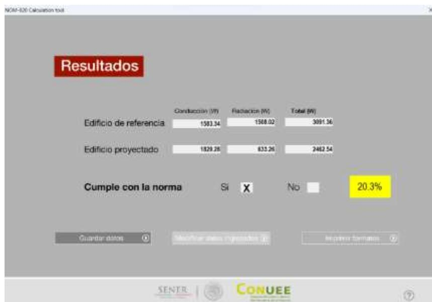
**Figura 3.** Resultados NOM-020 Calculation tool. Fuente: elaboración propia.
