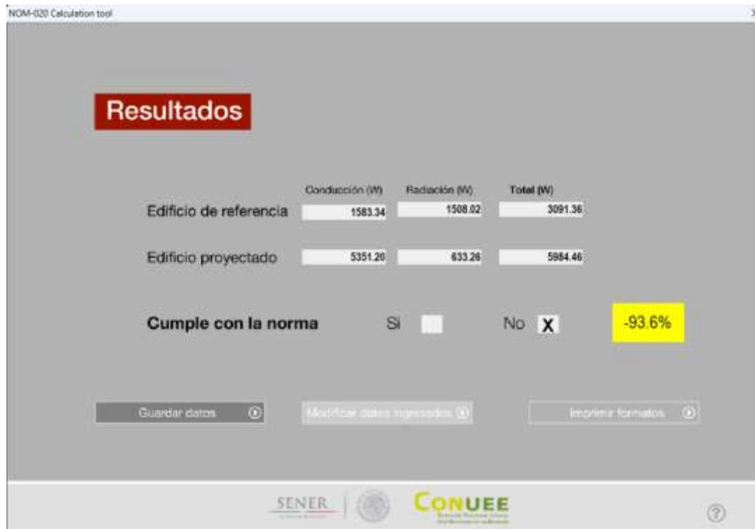
**Imagen 5.** Resultados simulación sin aislante; NOM-020 Calculation tool. Fuente: elaboración propia.
