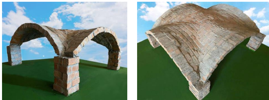
Figuras 30 y 31. Bóveda de Arista Terminada. Fuente: Morales (2021).
