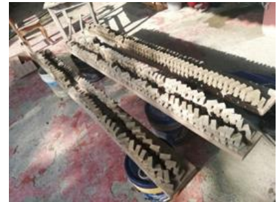
Figuras 5, 6 y 7. Proceso de elaboración de los ladrillos a escala (Finalizado del proceso del secado de 4 días para posteriormente meterlos al horno para el proceso de cocción. Fuente: Quinteros & Morales (2021).
