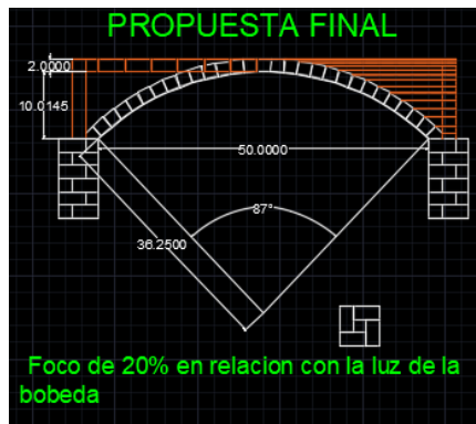
Figuras 31 y 32. Geometrización de la bóveda de esférica rebajada y sus soportes de arranque. Fuente: Morales (2021).
